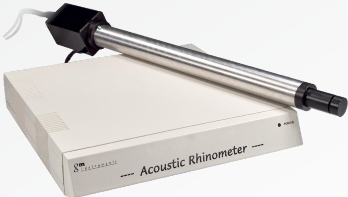
El rinómetro acústico A1 permite un análisis rápido y no invasivo de la cavidad nasal usando una técnica de emisión sonora.
