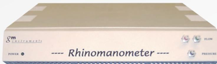
El rinómetro acústico permite un análisis rápido y no invasivo de la cavidad nasal usando una técnica de emisión sonora. El NR6 calcula la resistencia de la vía nasal, midiendo el flujo nasal y la presión producida.
