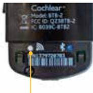
6. **ENCIENDA** el procesador de sonido. Un indicador luminoso parpadeará brevemente en color azul para informarle de que el enlace se ha efectuado correctamente.
