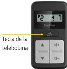
5. Para detener el streaming, **pulse brevemente la tecla de la telebobina**.
