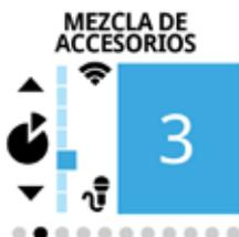
3. Pulse la **tecla de flecha hacia arriba o hacia abajo** para cambiar la mezcla.
