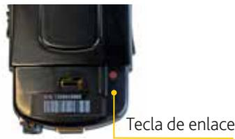
El LED de la parte superior de Mini Microphone parpadea en naranja durante 20 segundos. Debe encender el procesador durante este intervalo de 20 segundos para enlazarlo con Mini Microphone.
