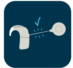
Tirantez del cable de antena – 35 N (3,5 kg)
