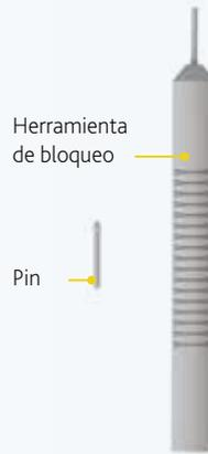
El codo con fijación de seguridad se suministra con la herramienta de bloqueo y pines de fijación. Utilice únicamente pines de fijación negros.
