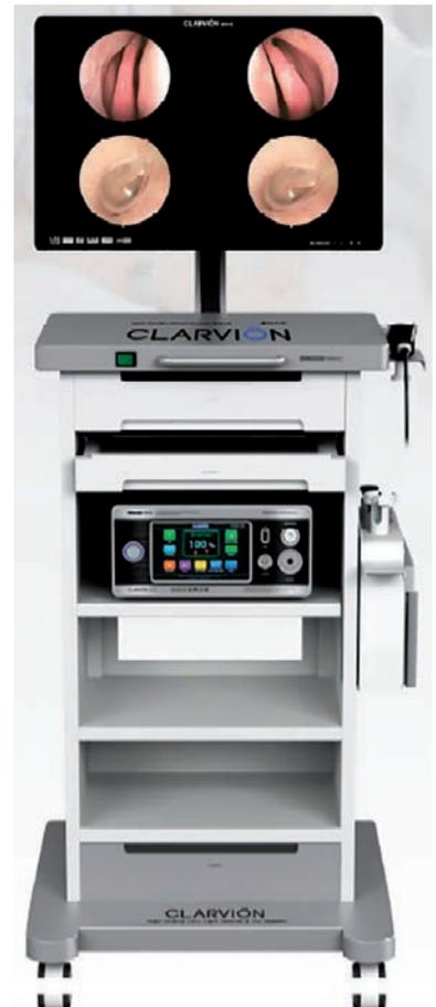
La cámara HD-CL3 es una cámara de 1 CCD para endoscopia y cualquier aplicación médica. El cabezal, de dimensiones reducidas, incorpora un chip de 1/3" CCD y un sistema de escaneo progresivo con sensibilidad de 1.0 Lux que proporcionan una gran claridad y definición de imagen de formato 16:9 y 1280 x 720 píxeles. El control totalmente digital de la imagen garantiza la reproducción real del color y del contraste. Además, este cabezal puede sumergirse en líquidos desinfectantes.
